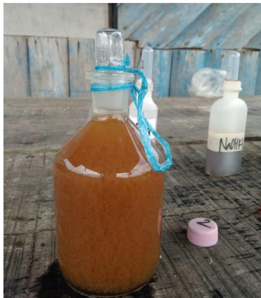
Gambar 8 Pengambilan sampel air kolam untuk penentuan kadar oksigen terlarut menggunakan uji laboratorium
