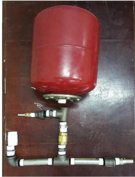
Gambar 7 Pompa grafitasi jenis hydram
